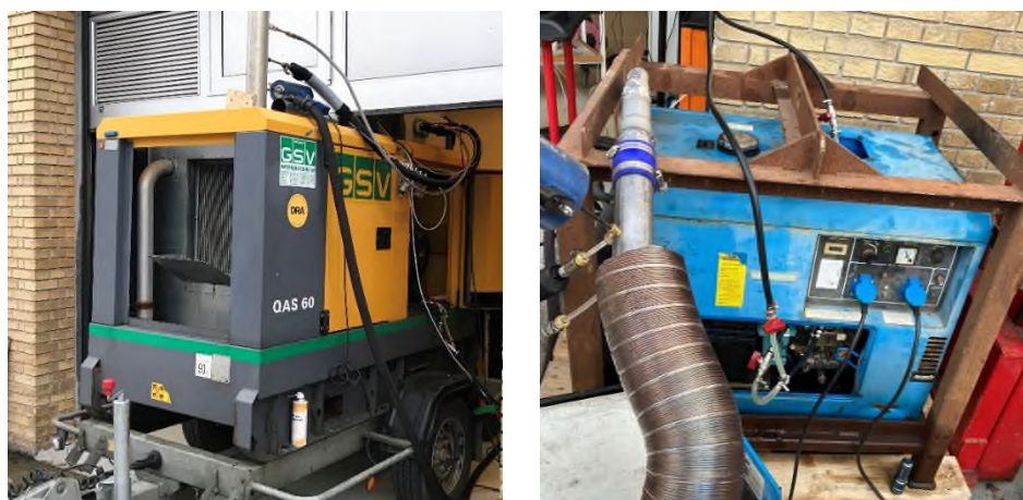
Figur 1. Billeder af de to generatorer anvendt i testen på hhv. 48 kW (til venstre) og 5 kW (til højre).
